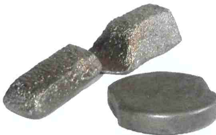
Figura 14: Amostras fundidas: lingotes e moeda.
